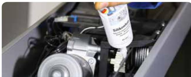
Fetten eines Kunststoffgetriebes
